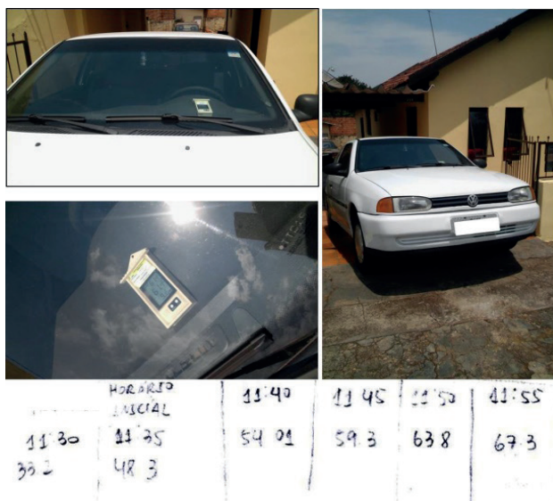
Figura 4 - Coleta de dados do aquecimento do veículo
